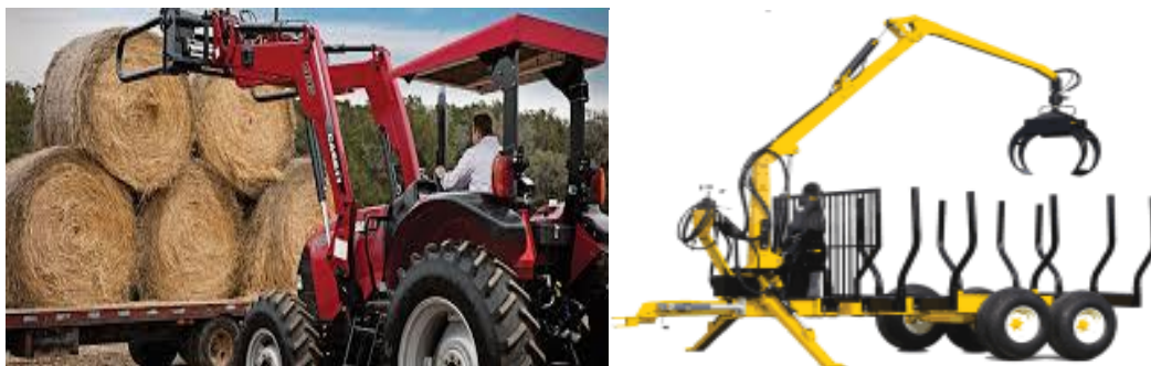
Сл. 7. Утоваривачи и транспортни приколицы за балирани по жетвени остатоци и сточна храна.
