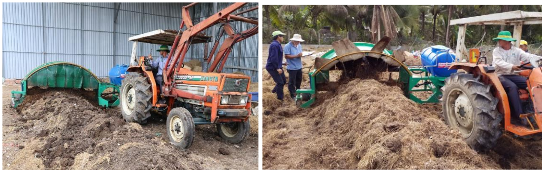
Сл.8. Приклучни машини со трактор за подготовка на био маса за компостирање, [17].
